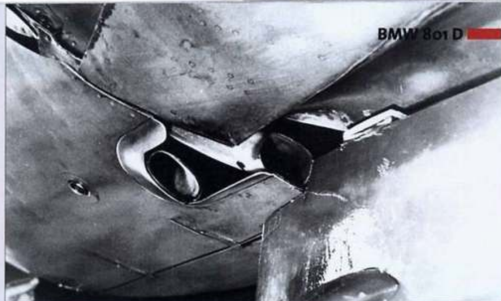
Links ist hier unter dem Rumpf der Fw 190 die Abgasdüse für den Zylinder 8, rechts daneben die Doppeldüse für den Zylinder 9 und 10 zu sehen. Die Doppeldüsen verursachten maßgeblich den unruhigen Motorlauf des BMW 801.
