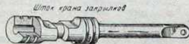
Фиг. 62. Распределительный кран закрылков (обозначения те же, что и на фиг. 61).
