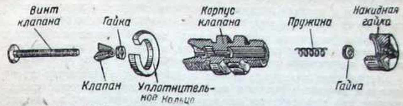
Фиг. 51. Детали зарядного клапана стойки хвостового колеса.
